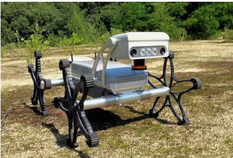
Asguard v4 er en sikkerhetsrobot utviklet ved Deutschen Forschungszentrums für Künstliche Intelligenz i Bremen. (Foto:Felix Grimminger, DFKI GmbH)
